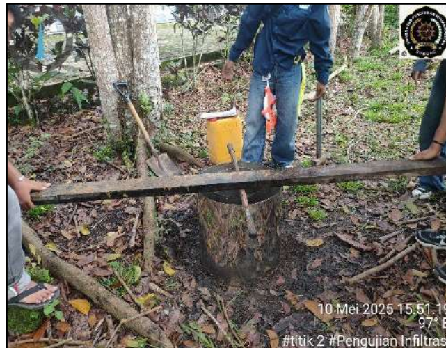
Gambar 4. 2 Pengujian laju infiltrasi pada titik 2
