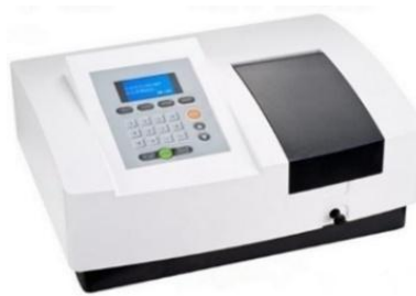
Gambar 2.5 Spektrofotometri UV-Vis (Sumber: Putri, 2024)
