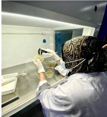
Gambar 39. Pengukuran diameter zona hambat dilakukan menggunakan jangka sorong
