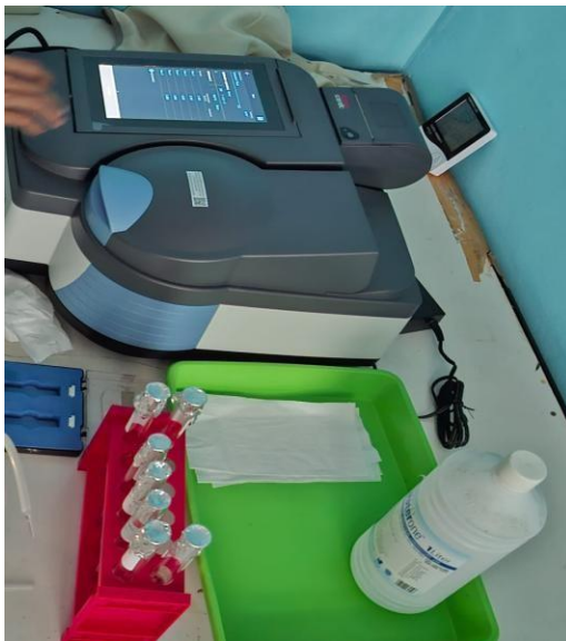
Gambar 31. Pengukuran kadar kolesterol menggunakan spektrofotometri UV-VIS
