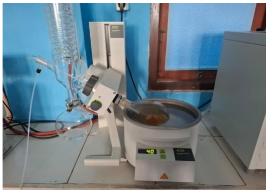
Gambar 19. Penguapan ekstrak kulit buah naga merah menggunakan rotary evaporator
