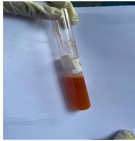
Gambar 10.18 Hasil Skrining Pelarut Etanol 96% Senyawa Saponin
