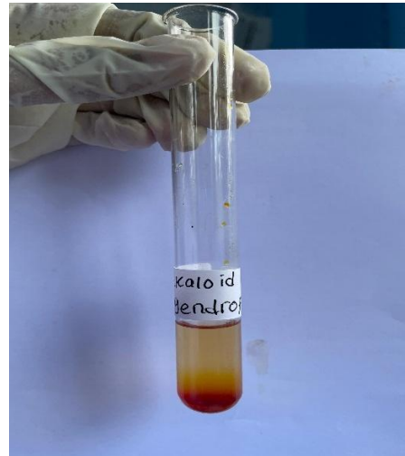
Gambar 10.16 Hasil Skrining Pelarut Etanol 96% Senyawa Alkaloid Pereaksi Dragendorff
