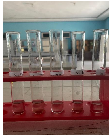
Gambar 20.37 Hasil Uji DPPH Ekstrak Biji Buah Merah Etanol 96%
