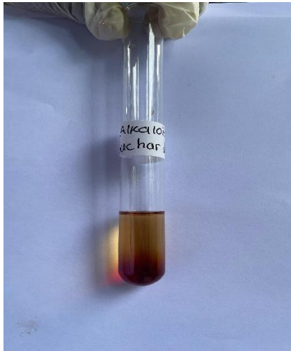
Gambar 10.15 Hasil Skrining Pelarut Etanol 96% Senyawa Alkaloid Pereaksi Bouchardat
