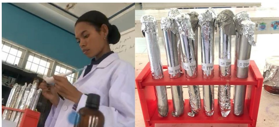
Gambar 3.18 Pembuatan larutan DPPH, pembanding vitamin C dan larutan sampel sarang semut
