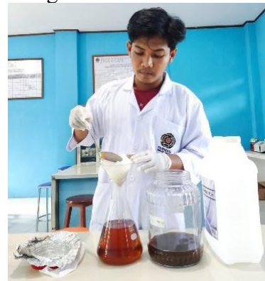
Gambar 3.8 Ekstraksi dan penyaringan ekstrak cair sarang semut
