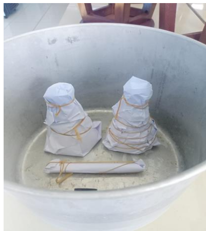
Gambar 4. Peneliti melakukan sterilisasi alat yang akan digunakan menggunakan autoclave pada suhu 121°C selama \pm 15 menit
