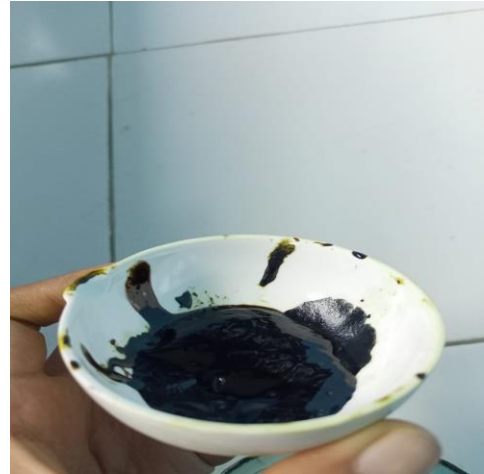
Gambar 3. Hasil ekstrak kental yang didapatkan dari proses maserasi sebanyak 21 g
