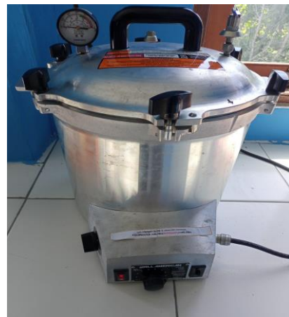
Gambar 4. Peneliti melakukan sterilisasi alat yang akan digunakan menggunakan autoclave pada suhu 121°C selama \pm 15 menit
