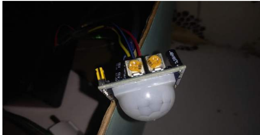
Gambar 4. 5 Pengatur sensitivitas pada sensor PIR
