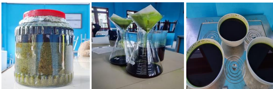
Gambar 3.3. Proses ekstraksi dengan menggunakan metode maserasi
